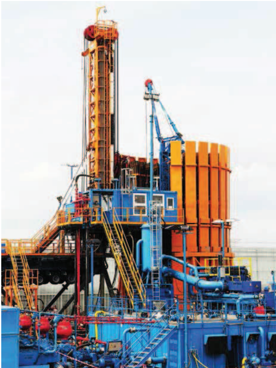
De boortoren die naar aardwarmte gaat boren, hier bij Wijnen Square Crops, die de eerste aardwarmtebron in het gebied in gebruik heeft genomen.
